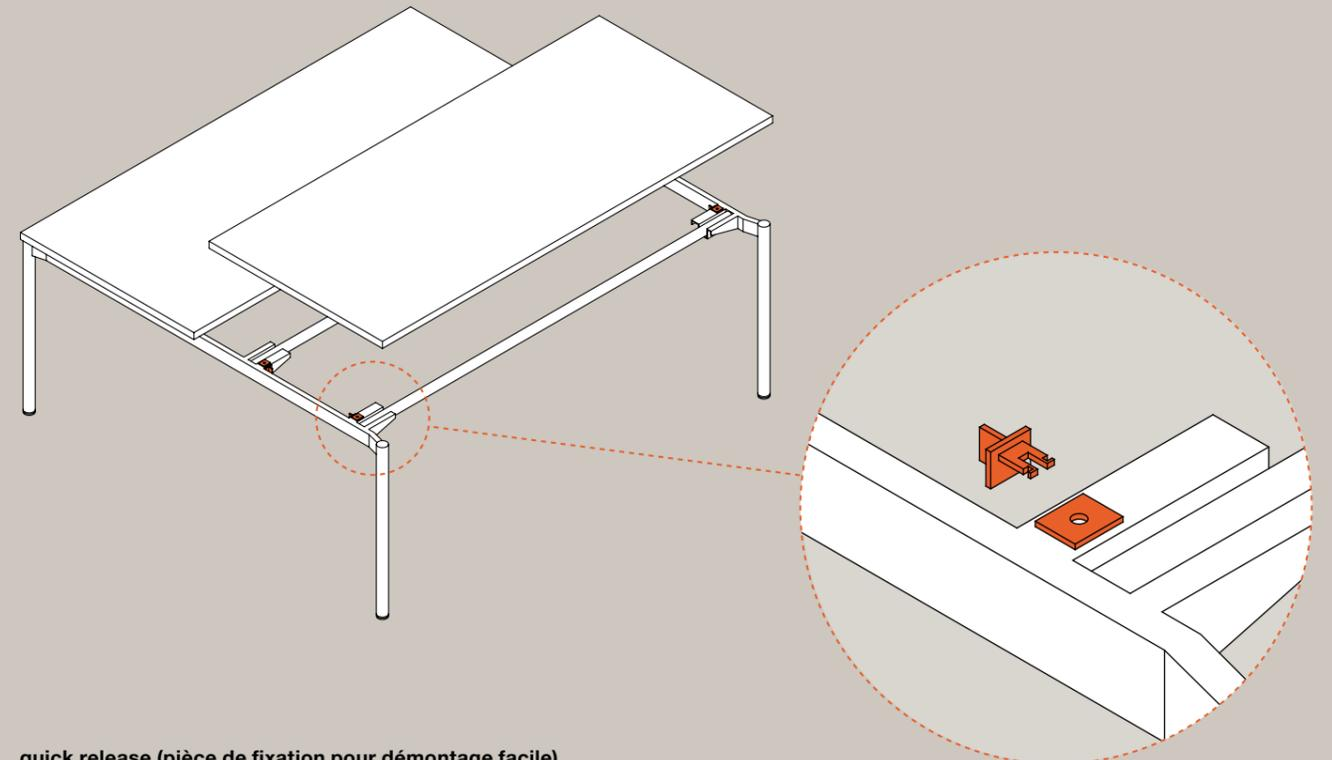
quick release (pièce de fixation pour démontage facile)
