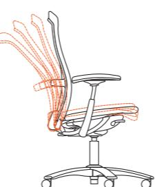
**Rückenlehne mit Synchronmechanik und selbstregulierender Neigungsfederung**
